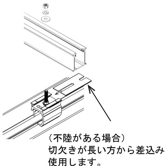
※トルク管理のできるドライバーで締付トルクは約 2.7 ~ 3.0 [N・m]。
