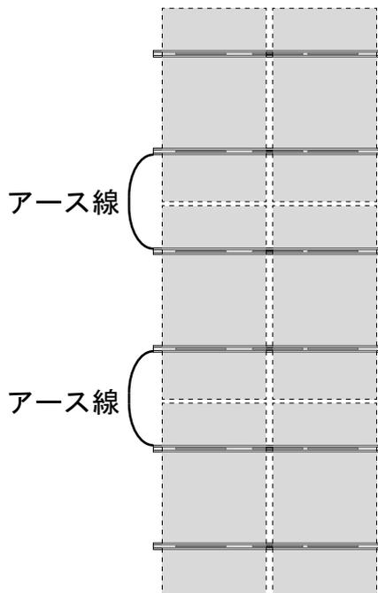
圧着端子の付いたアース線（現場調達品）を縦ラックけらば側の側面にビス（現場調達）で打込み列方向のアースを取ります。
