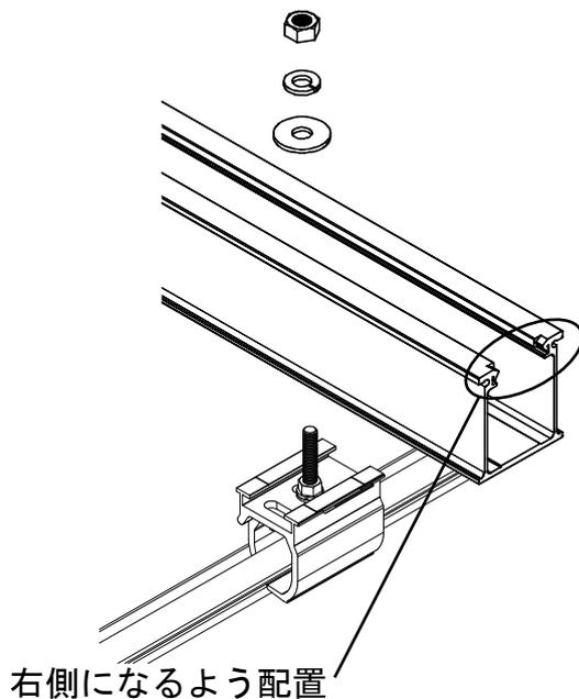
取付金具に角根ボルト (M8×35) を通し、ボルト抜け止めをつけ、縦ラックをワッシャー・スプリングワッシャー・ナットで仮固定します。
