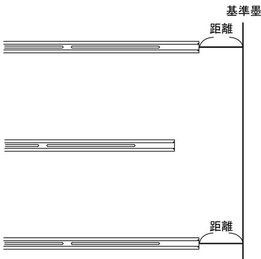
①軒側・棟側の縦ラック先端を基準墨からの距離を合わせ、平行に固定します。
