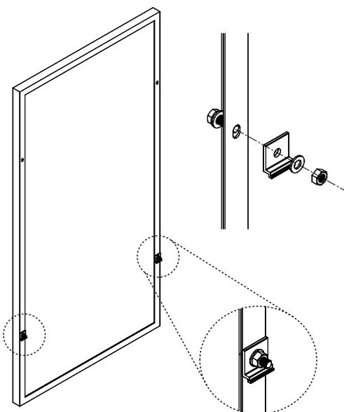
①モジュール裏面のフレームに開いている固定穴に裏側からボルトを通します。
