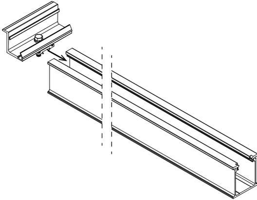
端部固定金具を挿入します。
