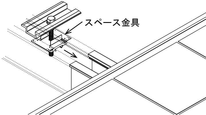
中間固定金具を縦ラックに通しスペース金具がモジュール下に入るように設置します。
