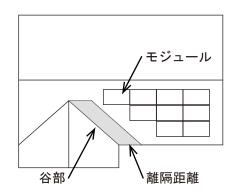
(4) 稀に積雪量の多い地域で固まった雪が滑り落ちる際、カバーに引掛り変形する事例があります。 積雪量の多い地域では軒カバーを付けないことを推奨します。
