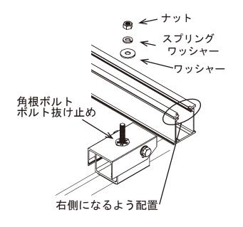
ワンカチの角根ボルトに縦ラックを通 しワッシャー・スプリングワッシャー・ ナットで仮固定します。
