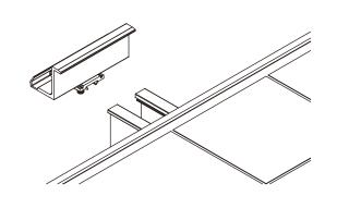
端部固定金具を通し、電動ドライバーに六角ソケット(対辺 10 mm)を取付け、ボルトを締め込みます。
