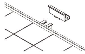
端部固定金具を通し、電動ドライバーに六角ソケット(対辺 10 mm)を取付け、ボルトを締め込みます。
