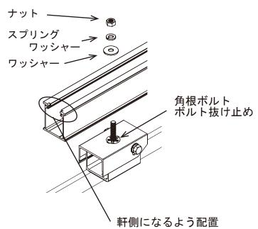
ワンカチの角根ボルトに縦ラックを通し ワッシャー・スプリングワッシャー・ ナットで仮固定します。
