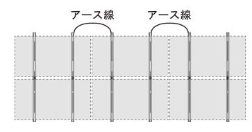
圧着端子の付いたアース線(現場調達品)を縦ラック棟側の側面にビス(現場調達)で打込み列方向のアースを取ります。
