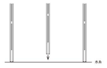
②けらば側の縦ラック先端に水糸を 張り残りの縦ラックを水糸に揃え ます。
