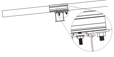
③モジュールを端部固定金具に差込み 仮置きします。
