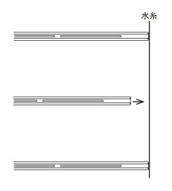
②軒側・棟側の縦ラック先端に水糸を 張り残りの縦ラックを水糸に揃え ます。
