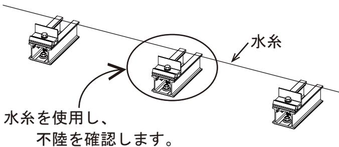
端部固定金具後側で金具の天端に水系を張り不陸を確認します。
