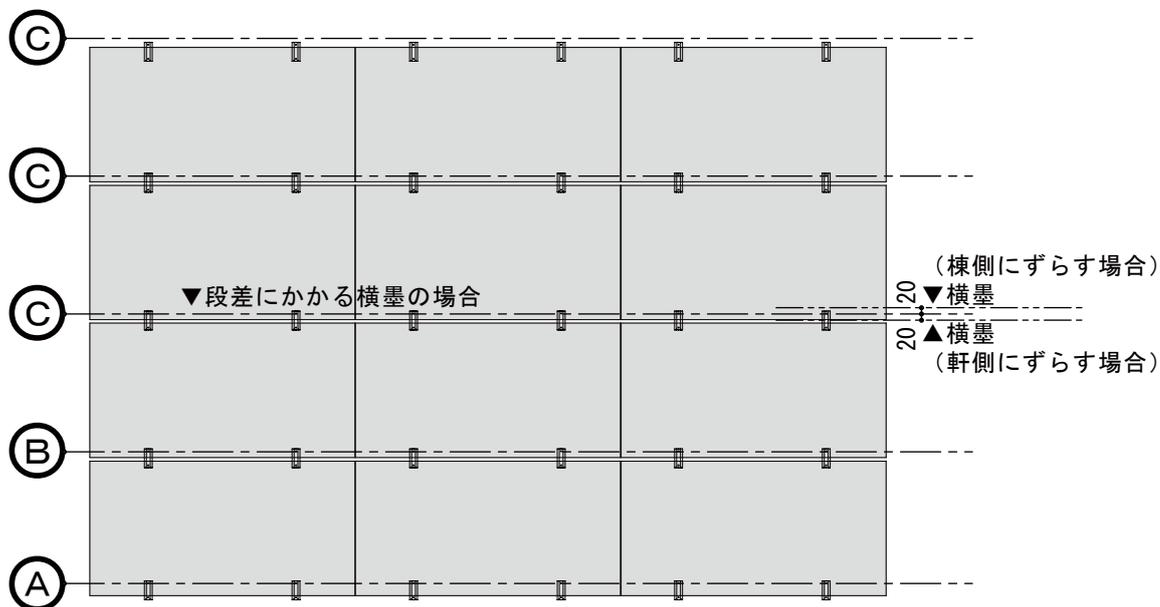
「1 墨出し」後、段差にかかる横墨 (B)(C) から軒側または棟側に 20 mm の位置に墨出しを行います。(横墨は軒棟どちらに出しても問題ありません。) 出した墨と縦墨 (A) の交点が金具棟側のビス穴位置となります。金具軒側のビス穴は「1 墨出し」同様 90 mm 軒側に墨出しを行って下さい。
