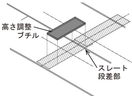
表・裏共に剥離紙を剥がし、高さ調整ブチルをスレート段差部分に貼付けます。
