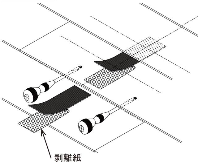
① マイナスドライバーを挿入しスレートを浮かします。
