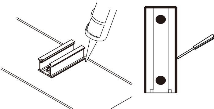
金具の — 部分 3 辺とビス頭・ビスまわりをゴムアス系コーキング材で防水処理し、ヘラを使用し整えます。
