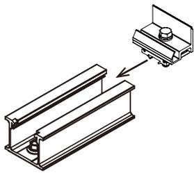
端部固定金具を棟側から挿入します。
