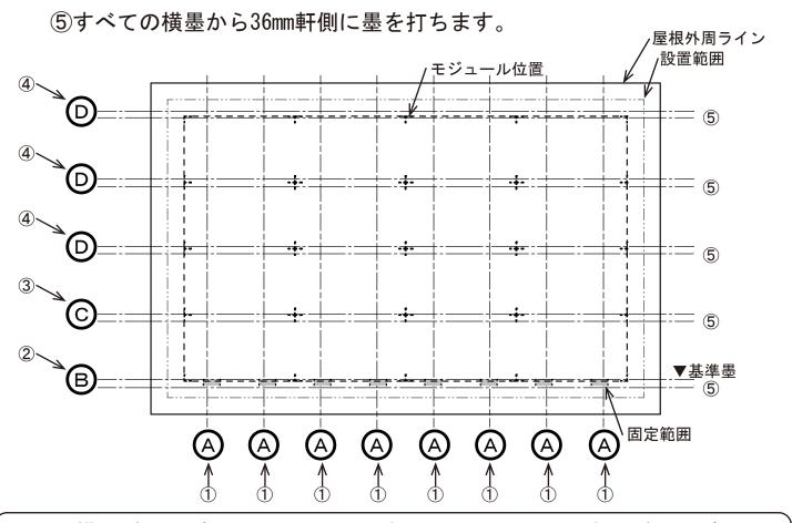
横墨が剣先ボルトから36mm以上離れていない場合、金具が剣先ボルトに 干渉し、金具の取付けができません。レイアウト全体を調整し、干渉し ない位置に再度墨出しを行ってください。
