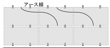
本陽電池モジュールの縦(段)方向は 中間固定金具で導通を取れますが、横 (列)方向は導通が取れないため太陽 電池モジュールのアース穴を使いアー ス線で繋いでアースを取ります。
