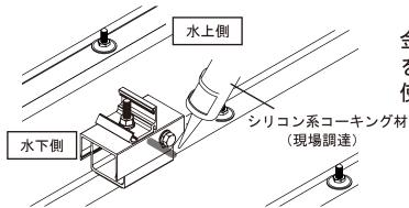
金具の水上側にシリコン系コーキング材 を十分塗布し、コーキング用へら等を 使用して丁寧に整えます。
